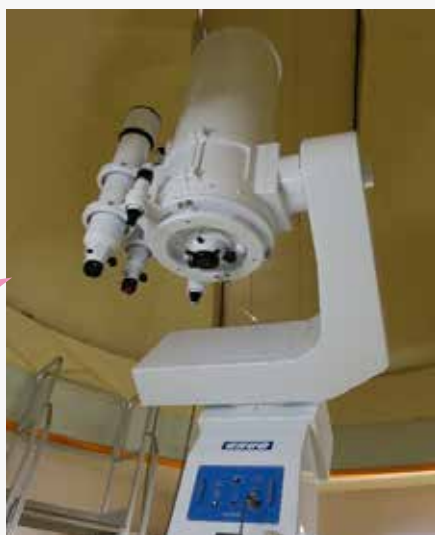
一宮地域文化広場観望室 L40C 反射式天体望遠鏡
